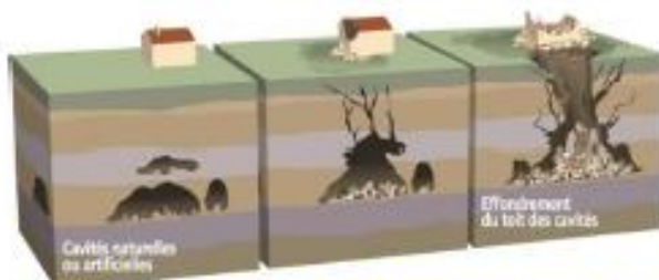
Figure 12 : Le risque d'effondrement des cavités
