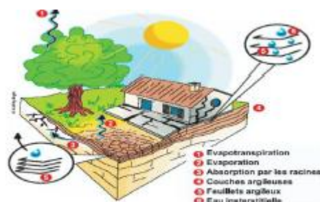
Figure 10 : Le risque lié au Retrait-Gonflement des argiles (DDT Oise)
